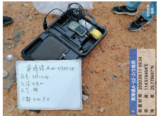
测电导率、溶解氧、氧化还原电位及 pH 值
