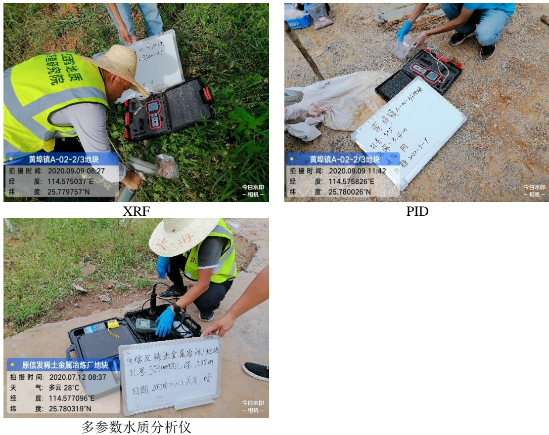
图 5-2-4 现场检测设备
